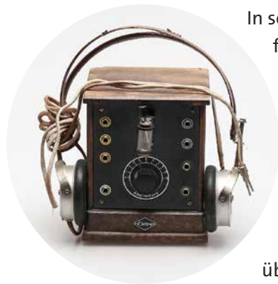
Um Anfang der 1920er Jahre Radio empfangen zu können, brauchten Hörerinnen und Hörer neben Kopfhörern auch einen sogenannten Detektor, der die Funkwellen mithilfe eines Bleiglanzkrystals in hörbare Frequenzen übersetzte. DRA, Ingrid Wichtrup
