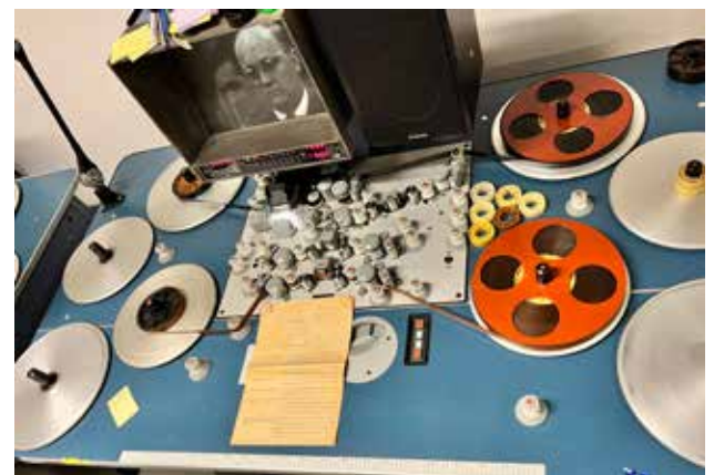
Ein vom Hessischen Rundfunk übernommener Schneidetisch aus den späten 1960er-Jahren steht den AV-Technikerinnen und Technikern des DRA seit Herbst 2022 für den Zusammenschritt von lose überlieferten Filmschnipseln zur Verfügung. DRA, Andreas Pättsch
